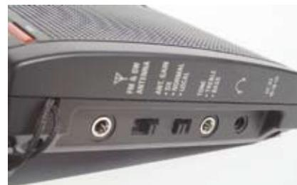
Sorvolo sulla possibilità di memorizzare 2000 (duemila!) emittenti, di ricaricare batterie NiCd e NiMH, di funzionare da radio sveglia, di spegnersi ad orari programmati, di segnalare lo stato di carica delle batterie e tanto altro. Ha, ovviamente, una presa per antenna esterna, una presa per alimentazione esterna (6 V, positivo a massa), una presa per
